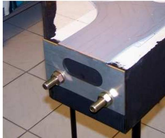
Wer nicht in der Lage ist die Bohrungen in den exakten Abmessungen herzustellen, der kann die Flansche auch mit Hilfe der Schablone positionieren:
